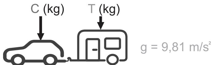
$$\text{D} \geq \frac{T \cdot C}{T+C} \cdot \frac{g}{1000} \text{ (kN)}$$
